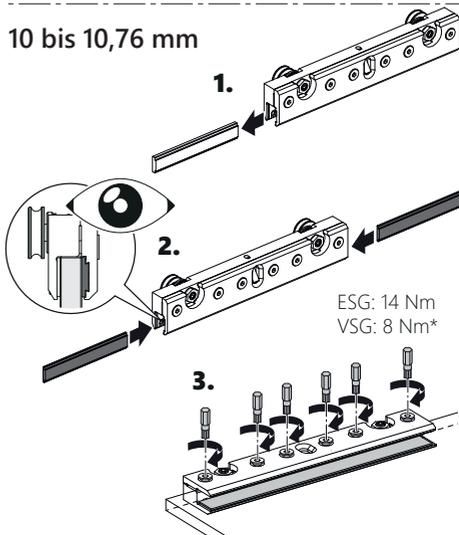
\* für eine sicherer Fixierung der Klemmböcken an der VSG-Scheibe wird das Verkleben mit einem Zwei-Komponenten-Kleber empfohlen.
