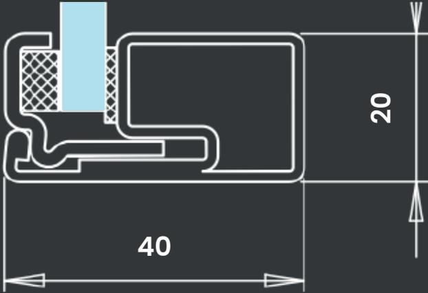
Die speziell gestaltete Form der Profile aus hochwertigem kaltgewalzten Stahl mit einer Profilstärke von 1,5 mm, ermöglicht die Herstellung außergewöhnlich schlanker Türrahmen, ohne dabei auf Haltbarkeit zu verzichten. Diese Türrahmen bleiben über Jahrzehnte hinweg beständig und robust.
